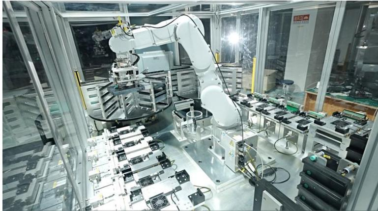
②采用高精度视觉相机实现了被测产品的自动识别，满足被测产品多种类、多批次、多工位混合测试需求。
